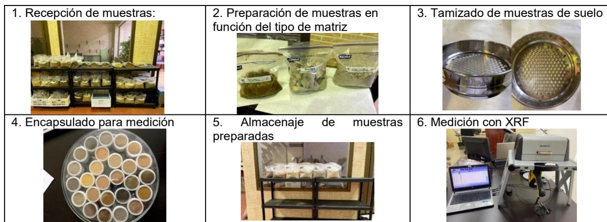
Figura 1. Procedimiento implementado para la recepción, preparación y análisis de muestras con el XRF en laboratorio
