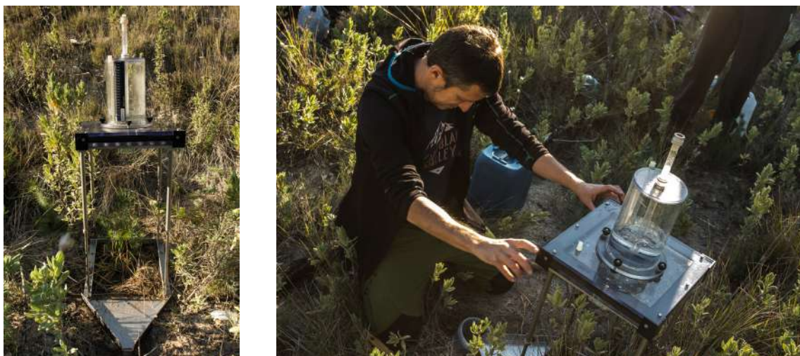
Figura 5. Simulador de lluvia portátil utilizado en el estudio, diseñado por Kamphorst (1987) (fotografías: Pablo Aranáz, 2015)
